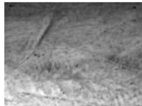
図3 図2の全動画を構成する数値データの平均値から求められた無方向性珪素鋼板の静的磁区画像
